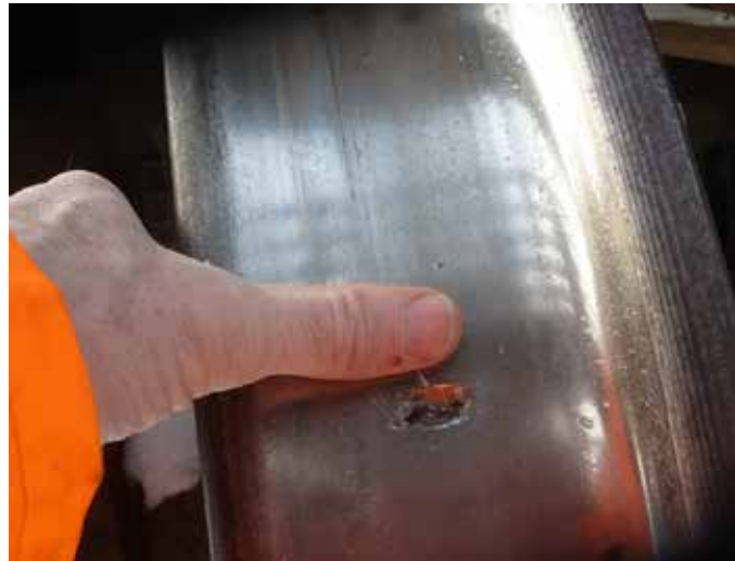
Photo 1. Surface de roue endommagée sur le wagon PROX 035435
