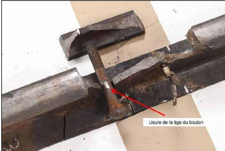
Photo 2. Usure de la tige du boulon
