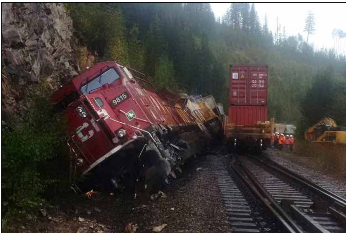
Photo 1. Les 2 locomotives du train 602 qui ont déraillé à l'extrémité est de la voie d'évitement de Beavermouth (vue vers l'ouest)
