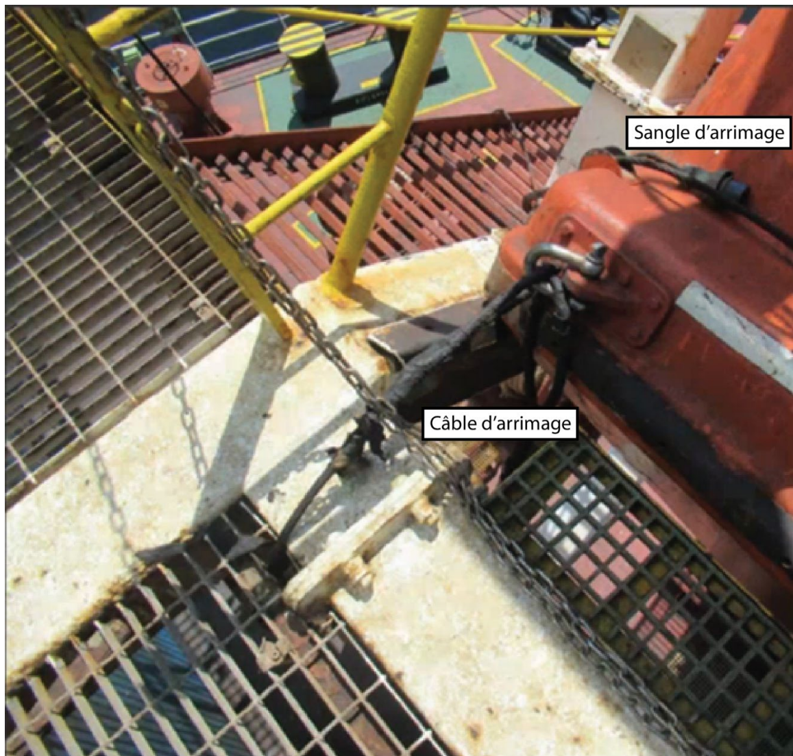
Figure 9. Les dispositifs d'arrimage de l'embarcation de sauvetage mise à l'eau en chute libre, comprenant les câbles d'arrimage et une sangle d'arrimage, avant l'événement à l'étude (côté bâbord de l'embarcation de sauvetage) (Source : Columbia Shipmanagement Ltd.)
