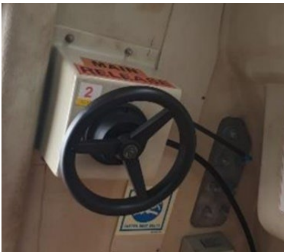
Figure 12. La roue de largage à bord de l'embarcation de sauvetage (Source : Columbia Shipmanagement Ltd.)
