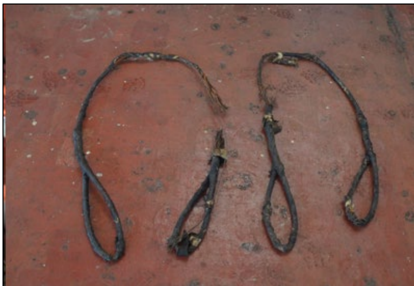
Figure 10. Les 2 câbles rompus, après l'événement (Source : BST)
