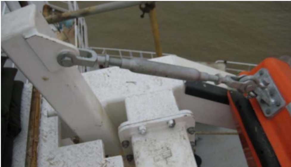
Figure 11. Tendeurs servant à arrimer l'embarcation de sauvetage pendant l'entraînement et l'entretien, conformément aux recommandations du fabricant (Source : Viking-Norsafe AS)
