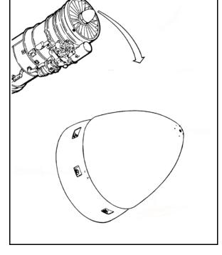
Le cône d'entrée d'air est déposé pour permettre certaines inspections du moteur et certains remplacements de pièces. Le cône
