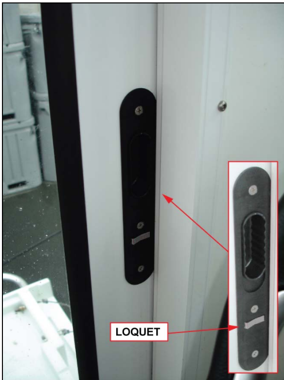
Photo 4. Loquet intérieur de la porte bâbord
