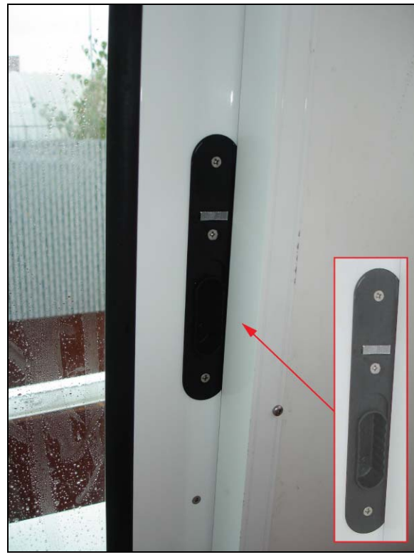
Photo 5. Loquet intérieur de la porte tribord (à noter la différence de position par rapport à bâbord)
