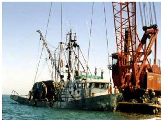
Photo 5. Le navire de pêche *Cap Rouge II* mesurant 14,7 m, redressé et attaché au chaland de sauvetage après qu'il a chaviré.
