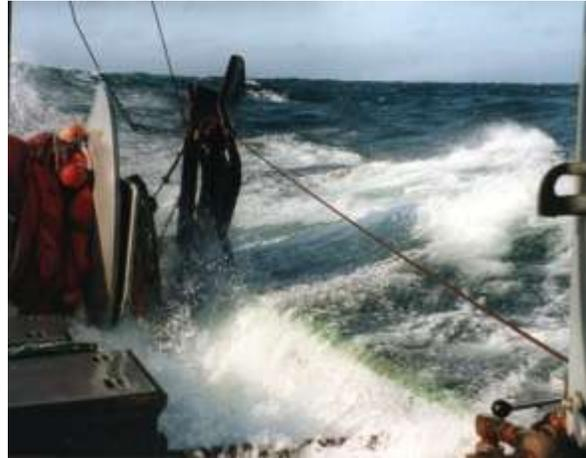
Photo 4. Une vague se brise contre le pavois et remplit le pont, illustrant l'importance de l'étanchéité du pont.
